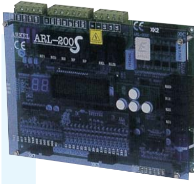
Halatlı asansörler için ekonomik kumanda kartı electronic controller card
